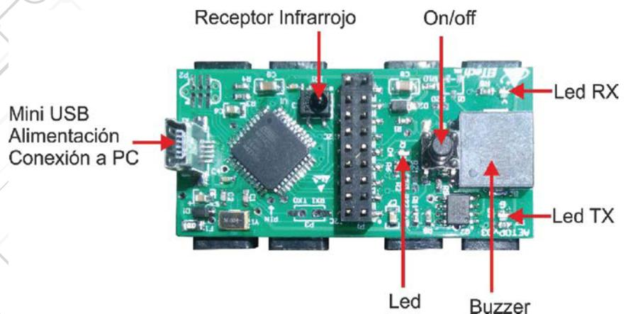
El ladrillo tiene varias conexiones. Por cada conector tiene alimentación +5V, masa y salidas/entradas digitales y/o analógicas.
