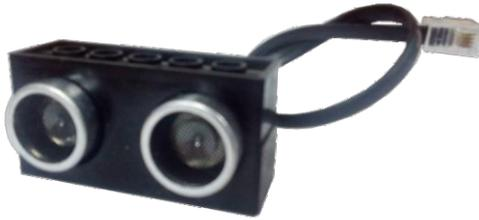
Este es un sensor de distancia por ultrasonido basandose en un HC-SR04 comunmente usado en Arduino. El sensor de distancia ultrasónico es una excelente opción si estás buscando un módulo ultrasónico potente pero barato y que sea compatible con Arduino y otras plataformas de microcontroladores. Su rendimiento estable es incomparable: la resolución es tan baja como de 3mm, tiene una alta precisión, funciona con 5V (DC), es altamente compatible con las tarjetas Arduino.
