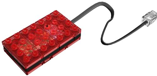
Con el modulo bluetooth HC-05 se puede conectar el ladrillo R8 a un telefono, tablet, pc etc. El módulo bluetooth HC-05 viene configurado de fábrica para trabajar como maestro o esclavo. En el modo maestro puede conectarse con otros módulos bluetooth, mientras que en el modo esclavo queda a la escucha peticiones de
