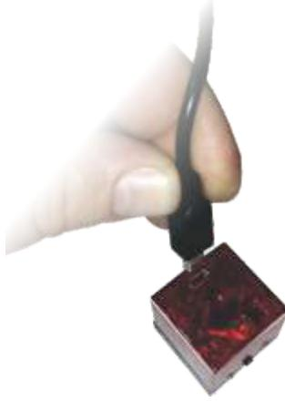
La primera vez se deberá esperar a que la computadora instale los controladores. Luego se debe seleccionar en Herramientas/Placa/Arduino Genuino Micro
